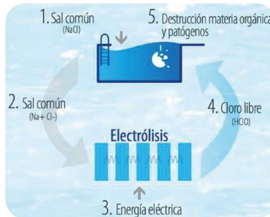
Ciclo cerrado, donde la sal se transforma en cloro y tras la destrucción de la materia orgánica o patógenos, el cloro se vuelve a transformar en sal.
