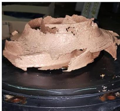
Este fenómeno se mantiene mientras la presión en la turbina sea baja, volviendo de nuevo a ser aire disuelto en el agua cuando se entra de nuevo a recuperar la presión en el interior de la turbina.
